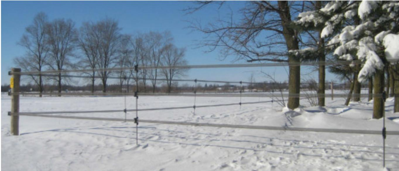
Le piquet en fibre de verre HorseGuard mesure 5,57 pi. /1,70 m. et devrait être enfoncé à une profondeur de 15 po /40 cm dans le sol. Avec un diamètre de 0,47" /12 mm il est incassable, intordable, imputrescible et quasiment indestructible. Sa fonction est de maintenir le ruban à la bonne hauteur sur la ligne.
