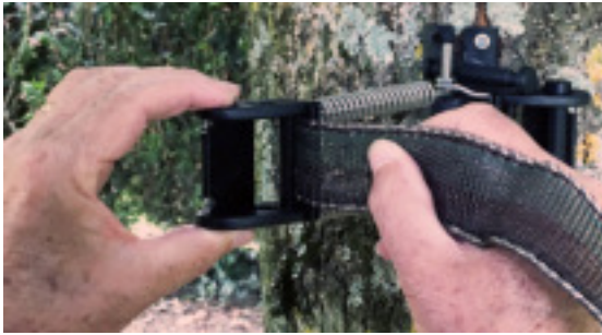
Insert the tape through the slot of the plastic buckle. Insérer le ruban à travers la fente de la boucle plastique.
