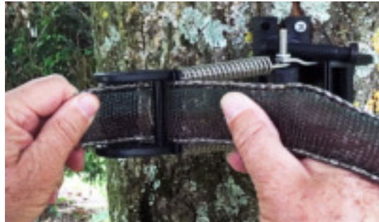
Now insert the tape back through the bigger slot. Repasser le ruban dans la plus grosse fente.
