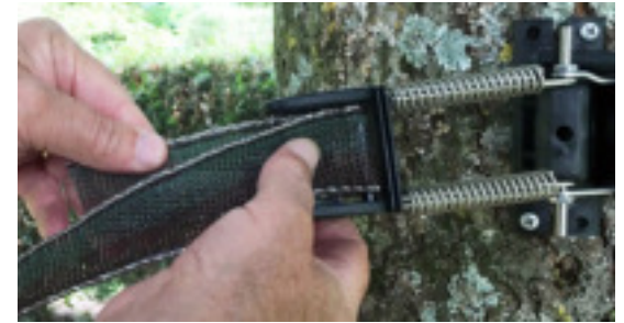
Press the two sections of tape together at the bottom of the buckle. The end of the tape is in the back. Poussez les 2 parties du rubans bien au fond de la boucle. La fin du ruban est à l'arrière.
