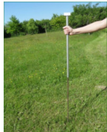
Installation du piquet fibre de verre avec l'enfonce piquet #49
