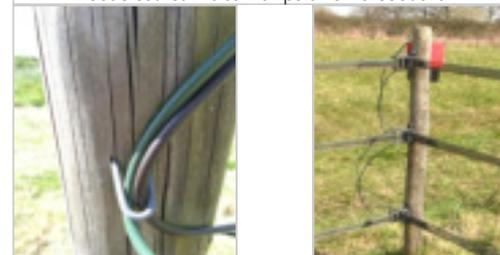
Piquet des connexions avec câbles HorseGuard #28V + #28M
